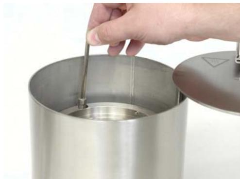
Muffelringhalter ohne Adapterring einsetzen und mit den drei kurzen Inbusschrauben befestigen. Inbusschrauben gleichmäßig handfest anziehen.
