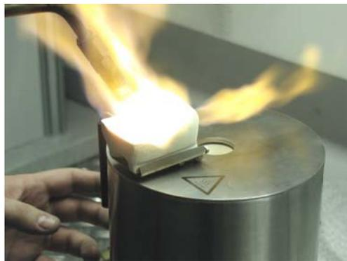
Bei optimaler Konsistenz der Schmelze kann diese durch Umlegen des Schmelztiegelgriffes **13** in die rotierende Muffel gegossen werden.
