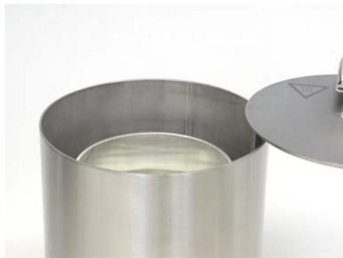
Mit dem mitgelieferten Inbusschlüssel die drei Inbusschrauben des Muffelringhalters lösen. Muffelringhalter und darunterliegenden 3 cm hohen Adapterring aus dem Gerät herausnehmen.
