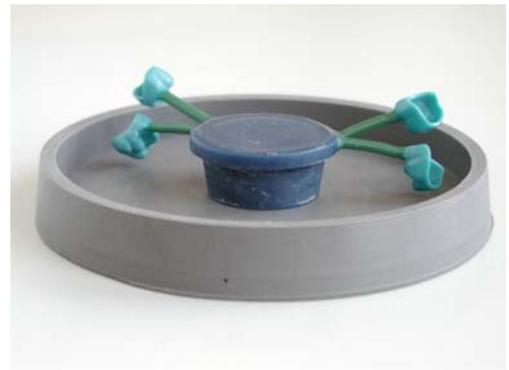
Zur Vermeidung von Lufteinschlüssen ist unbedingt darauf zu achten, daß unter sich gehende Bereiche des Gußobjektes stets zumindest parallel zum Muffelboden, besser jedoch mit der Öffnung nach oben geneigt positioniert werden.
